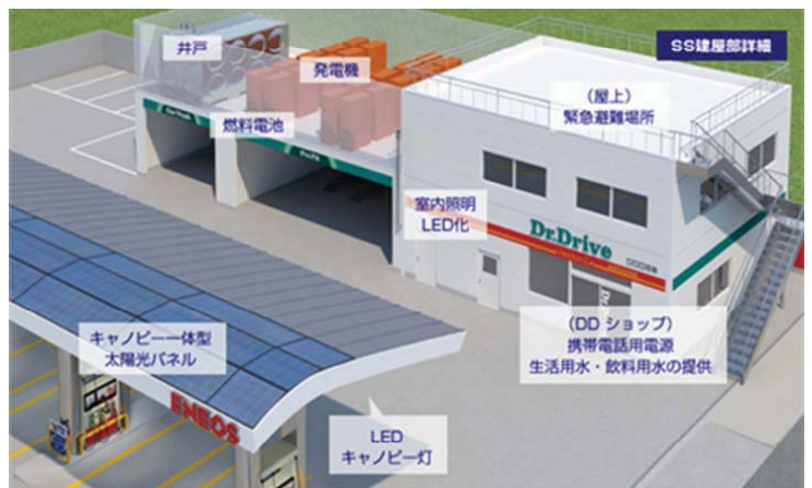
LED照明や太陽光パネル等を設置したSS(災害対応SS)
