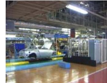
エンジン,ミッション,シート,計器類,バンパー,窓ガラスなど内外装部品を取り付ける。
