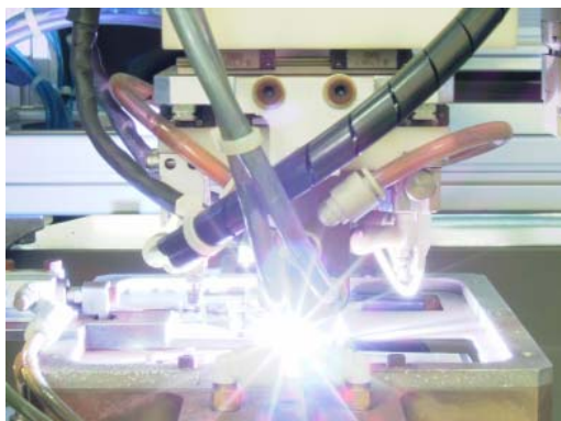
電動パワーステアリング用パターンのTIG溶接
