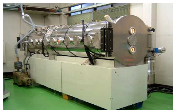
世界最大の4mのDLC成膜装置
