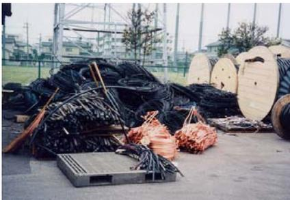
古くなって取り替えた銅電線やアルミ電線を切断、破碎し、材質ごとに分別する
