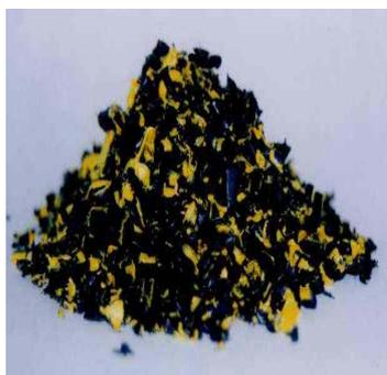
樹脂カバー類を材質ごとに分別するとともに、破碎・洗浄し、再原料化(リペレット)する
