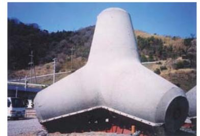
セメントにフライアッシュ等を混ぜることで、セメント使用量の低減のみならず、強度増加等の優れた特徴を持つコンクリート製品が製造できる（写真は消波ブロック）
