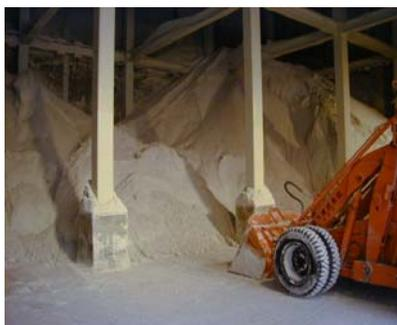
火力発電所の排煙脱硫装置から取出した石膏(副品)
