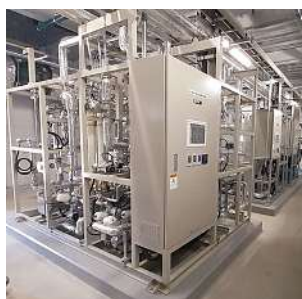
膜式注射用水製造装置。国の補助金対象「先進設備・システム」として採択
