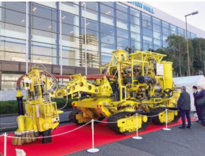
コバルトリッククラスト掘削試験機
