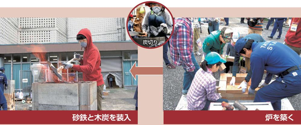
たたらは日本古来の製鉄法で、鉄を原料とし、砂鉄と木炭を交互に炉に装入して3昼夜操業し、木炭の燃焼を通して砂鉄を還元して鉄を得る。6世紀後半に朝鮮半島から伝えられたと言われ、江戸中期に技術的に完成した。明治以降、高炉による近代製鉄法での生産が軌道に乗ったため、1923年に商業生産を終えたが、1977年に公益財団法人日本美術刀剣保存協会が文化庁の補助事業として島根県で復活させた。
